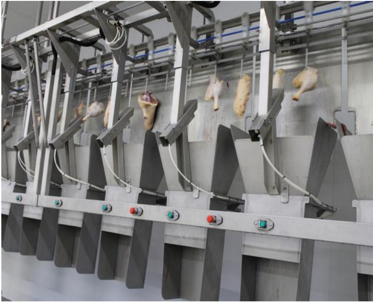
Vendée Concept a également développé une calibreuse aérienne à plateaux pour une meilleure ergonomie des postes. Les morceaux de volailles découpés sur la ligne à obus, sont déposés par les opérateurs dans des plateaux passant devant leurs postes de travail.
